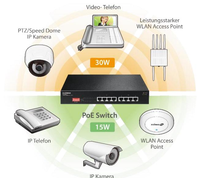
\*IP-Telefon: 3 - 7W, IP-Kamera: 7 - 10W, PZT-Kamera: 15 - 25+ W. Access Point: 8W für 802.11a/g Radios; oberhalb 20W für 802.11n Radios
