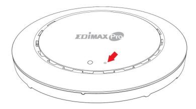
2. Warten Sie, bis der Access Point neu gestartet wird. Der Access Point für das Setup ist bereit, wenn die LED blau leuchtet.
