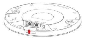
**2.** Verbinden Sie einen Router oder einen PoE-Switch über eine Ethernet-Kabel mit dem **LAN 1**-Port des Access Points.
